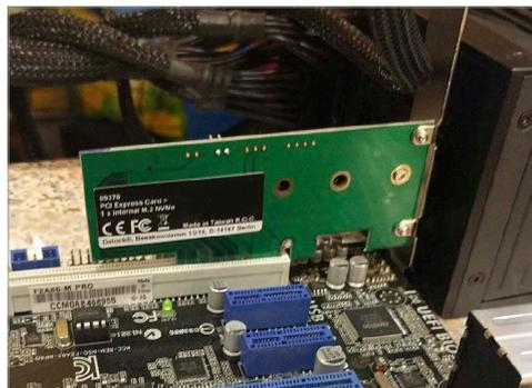
Hier arbeitet eine PCI-Express-Karte in einem längeren x16-Slot. Der umgekehrte Fall, der Betrieb an kürzeren PCI-Slots, funktioniert jedoch nur selten.
