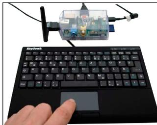
Tastatur und Touchpad in einem: Die Plastikastatur von Keysonic funktioniert am Raspberry Pi auf Anhieb, reicht für gelegentliche Arbeiten und spart einen USB-Port und Platz.
