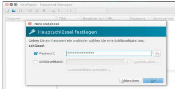
**Anlegen der Datenbank in KeePass-X: Der erste Schritt ist immer die Vergabe des Master-Passworts. Damit wird die KBD-Datei des Passwortmanagers verschlüsselt.**
