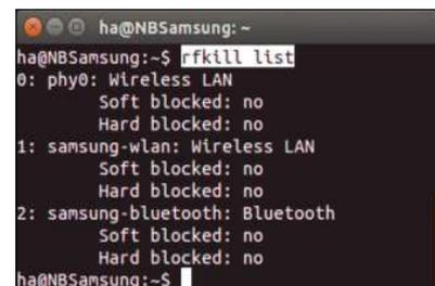
**Funknetze: rfkill zeigt die Schnittstellen und kann diese mit „block“ und „unblock“ ein- und ausschalten.**
