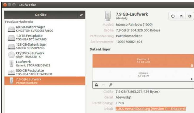
**Luks-Datenträger unter gnome-disks („Laufwerke“): Nach dem Entsperren erscheint parallel zur Luks-Partition eine virtuelle unverschlüsselte Partition, die alle Daten anbietet.**
