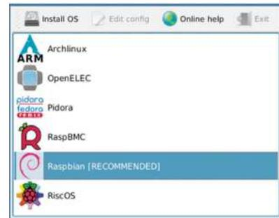
**Noobs-Installer für Raspberry: Der komfortable Installationsmanager bietet eine Systemauswahl und dient als Notfallsystem.**
