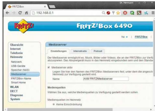
**Praktische Router-Erweiterung:** Mit einer am USB-Port angeschlossenen Festplatte wird die Fritz!Box im Handumdrehen zum UPnP-Medienserver oder zum NAS-Datei-Server.
