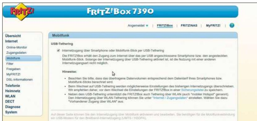
**Ob als Fallback oder für unterwegs: Über ein Smartphone greift die Fritzbox auch per Mobilfunk auf das Internet zu. Die Einrichtung an den beiden Geräten ist sehr einfach.**
