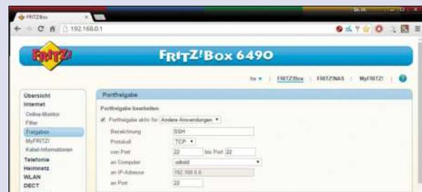
**Portfreigabe für den Webzugriff: Was von außen auf Port 22 zum Router kommt, wird erlaubt und zum Port 22 des Zielrechners geschickt. Ein geänderter ankommender Port erhöht die Sicherheit.**
