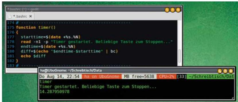
**Einfache Stoppuhr:** Die Funktion „timer“ speichert die Startzeit. Nach beliebigem Tastendruck errechnet sie die exakte Differenz zur Endzeit und zeigt das Ergebnis an.
