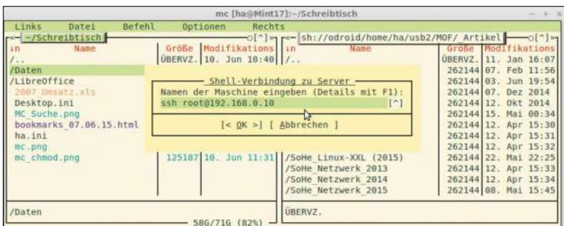
**Der Midnight Commander als SSH-Client:** Damit tauschen Sie direkt Dateien zwischen dem lokalen Rechner (linkes Panel) und dem entfernten Server aus (rechtes Panel).
