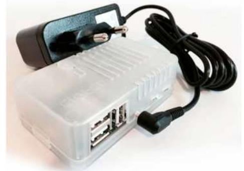
**Odroid U3 mit Vierkern-CPU und zwei GB RAM: Diese Platine ist teurer, aber leistungstärker als der Raspberry Pi 3, begnügt sich aber auch mit Fast Ethernet (100 MBit/s).**
