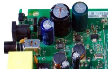
**Bei instabilem Router offenbart ein Blick in das Gehäuse den aktuellen Zustand: Durch Überhitzung blähen sich die Kondensatoren auf und platzen schließlich.**
