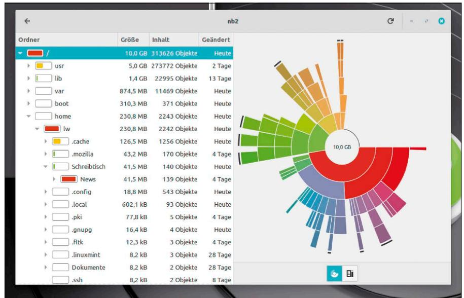
Festplattenbelegung: Das Tool Baobab visualisiert den Plattenplatz von Ordnern durch entsprechend große Segmente im Kreisdiagramm.
