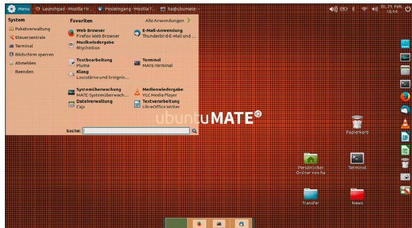
Nvidia vorliegt, kann Ubuntu Mate diese sehr wohl nutzen: Aufwendige 3D-Effekte lassen sich mit einem Wechsel zum mitgelieferten Fenstermanager Compiz aktivieren. Den Wechsel erledigen Sie unter „System -> Steuerzentrale“ über den Punkt „Mate Tweak-> Fenster“. In der Drop-down-Liste können Sie im laufenden Betrieb auf „Compiz“ umschalten. Ebenso schnell kommen Sie hier auch wieder zum angestammten und anspruchsvollen Marco-Fenstermanager zurück.
