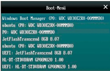
**Bootauswahl beim Gerätestart: Je nach Bios/Uefi führt eine Taste wie Esc, F9, F10, F11, F12 zu einer solchen Liste, auf der Sie den Datenträger mit dem Linux-System auswählen.**
