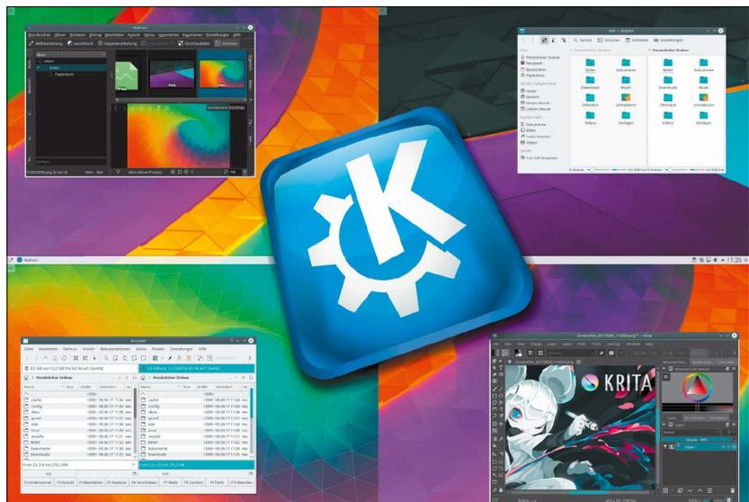
nennt sich „Plasma“ und verantwortet die Arbeitsoberfläche mit Miniprogrammen (Plasma-Widgets) und den Window-Manager Kwin. Der Window-Manager stellt Fenster, Programmdarstellung sowie Effekte bereit und kann mittels Open GL Hardwarebeschleunigung von Grafichips ausschöpfen und den Hauptprozessor entlasten. Ein Merkmal KDEs und seiner Programme ist der große Funktions-
