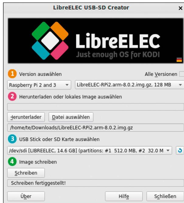
**Libre Elec installieren:** Dieses Installationsstool richtet das System auf einer SD-Karte für den Raspberry Pi oder auf USB-Stick für einen PC ein.
