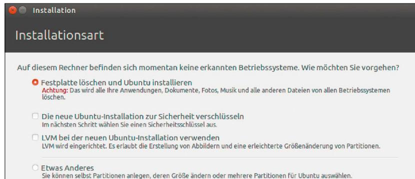
**Ubuntu alleine:** Ist kein weiteres System auf dem PC installiert, gibt es im Fenster „Installationsart“ nur die Option „Festplatte löschen und Ubuntu installieren“.
