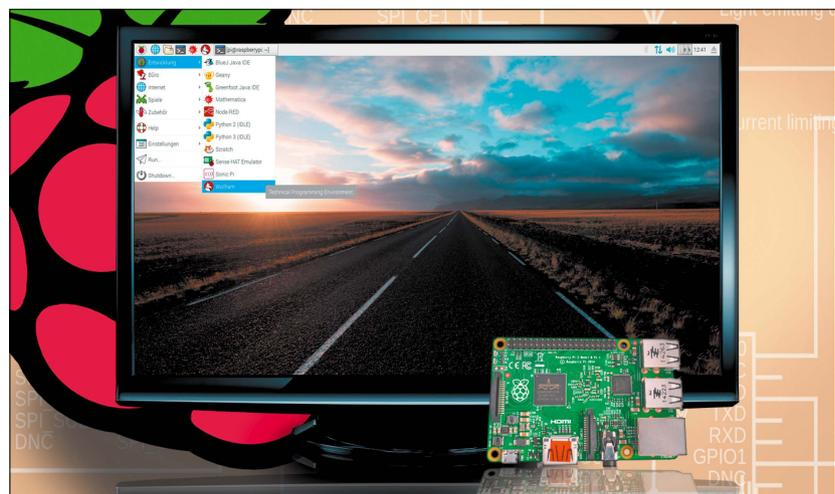
eine in die Jahre gekommene CPU-Generation von 2002. Auf dieser Platine laufen also nur Linux-Kernel, die noch für diese alte ARM-Version kompiliert wurden. Der Raspberry Pi 2 und 3 nutzen hingegen einen neuen Befehlssatz, nämlich ARM Version 7. Raspbian bringt deshalb zwei Kernel mit und die Firmware bootet je nach erkanntem Platinenmodell automatisch den passenden Kernel.
