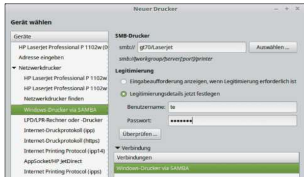
Netzwerkdrucker: Unter Linux Mint können Sie über das Netzwerk auch Drucker ansprechen, die auf einem Windows PC freigegeben sind („Windows-Drucker via SAMBA“).
